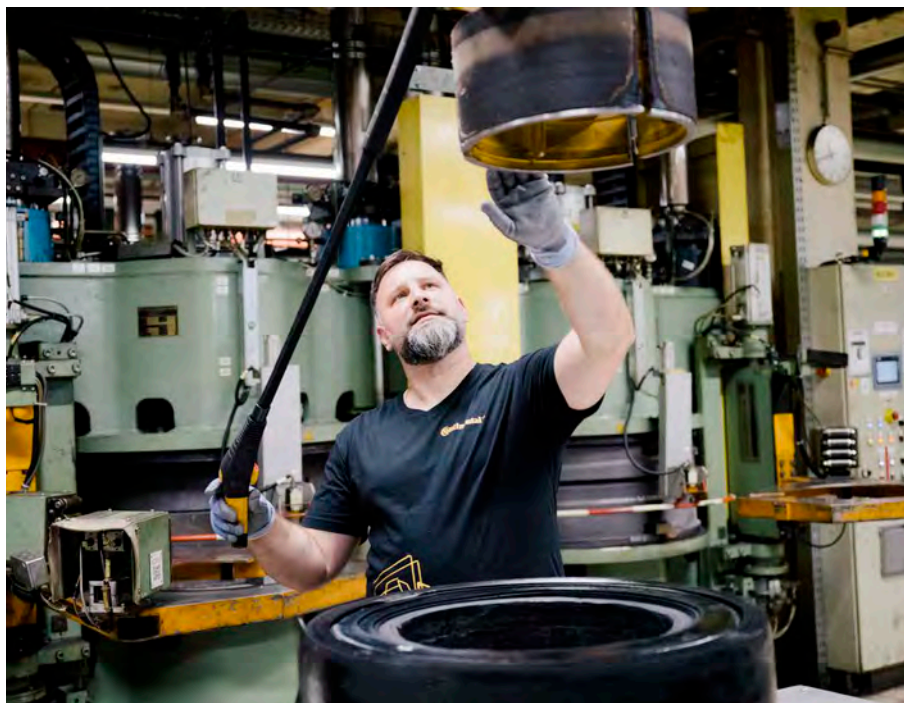
Aus Schichten einer Kautschukmischung gemacht: Eine Maschine hilft, die bis zu 400 Kilogramm schweren Reifen anzuheben.
