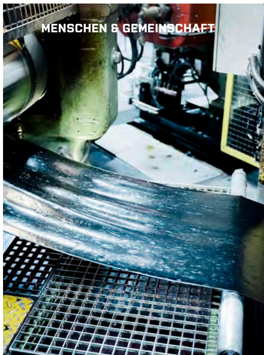
Aus Schichten einer Kautschukmischung gemacht: Eine Maschine hilft, die bis zu 400 Kilogramm schweren Reifen anzuheben.
